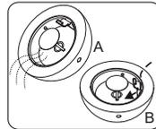
Ne versez pas l'eau par l'ouverture d'aération B (à gauche), sinon l'eau risque de pénétrer dans l'appareil, ce qui pourrait endommager les composants et entraîner une panne.
