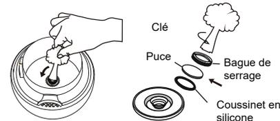
Tournez la barre de serrage dans le sens inverse des aiguilles d'une montre comme indiqué sur le dessin ci-dessus afin d'ouvrir le compartiment. Enlevez l'ancienne puce et placez la nouvelle face avant vers le haut sur la languette et le coussinet en silicone. Tournez bien la bague de serrage dans le sens des aiguilles d'une montre pour refermer.
