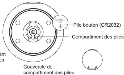
(voir dessin). Remplacez le couvercle et fixez-le en le tournant dans le sens inverse des aiguilles d'une montre.
